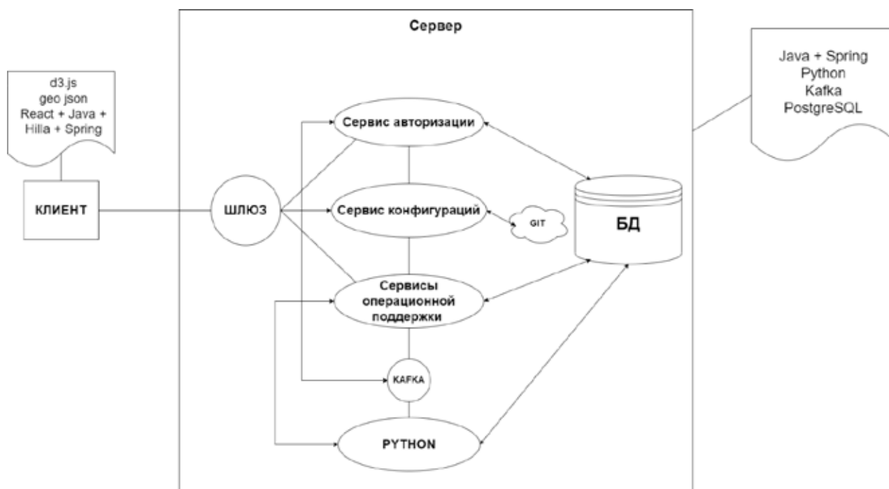
Рис. 1. Компоненты системы CNOSS Fig. 1. Components of the CNOSS system
